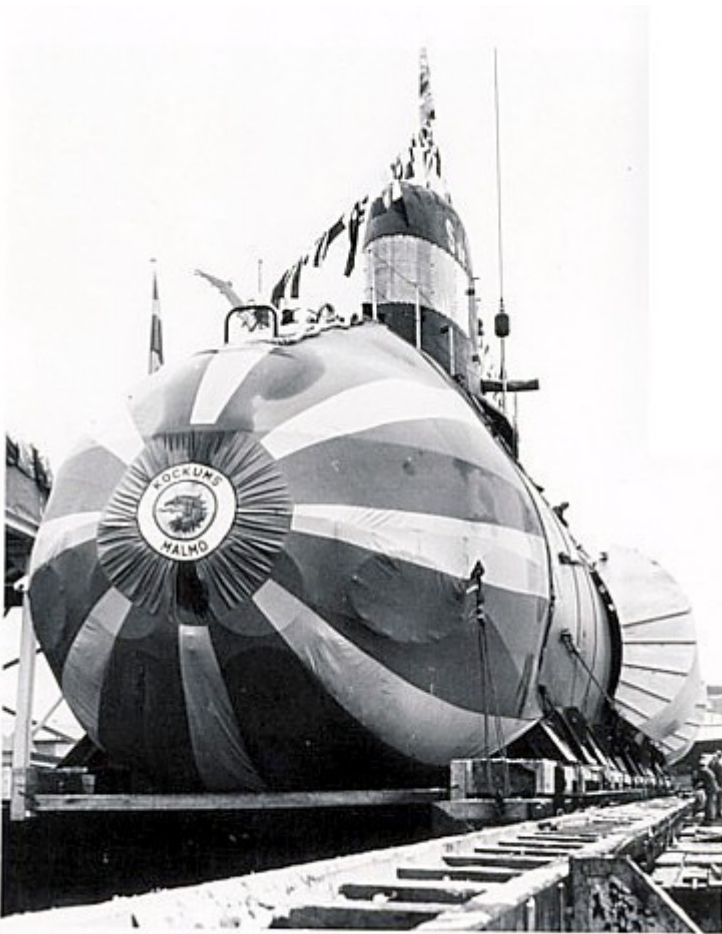
Sjöormen före sjösättning är en imponerande syn. Fören täcktes dels av estetiska skäl, dels för att dölja antal och placering av torpedtuber. Som synes var det senare ett hopplöst företag.
