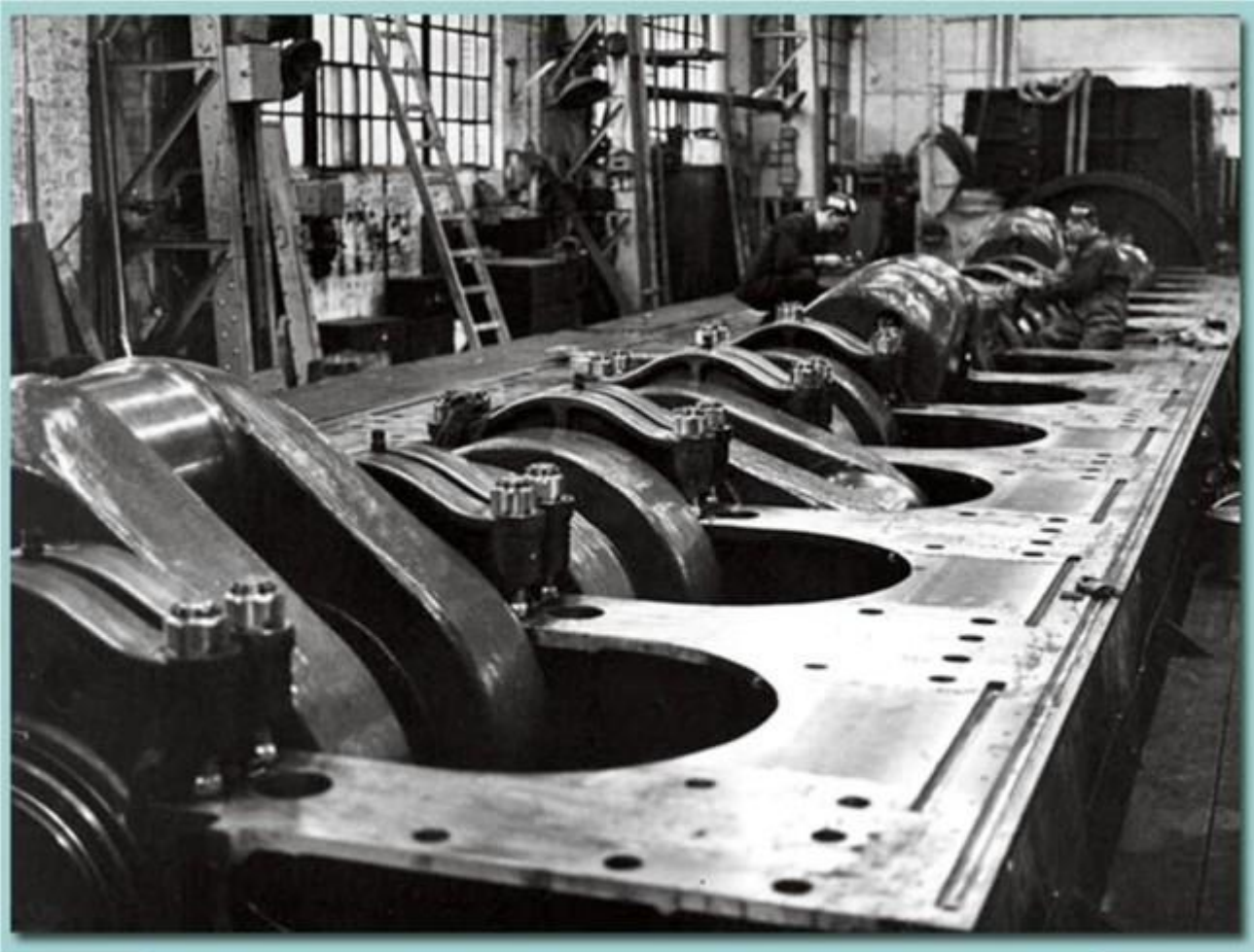
Bilden från 1961-01-10 Ramlager med vevaxel till en dieselmotor. Plats: Gamla maskinverkstaden.
