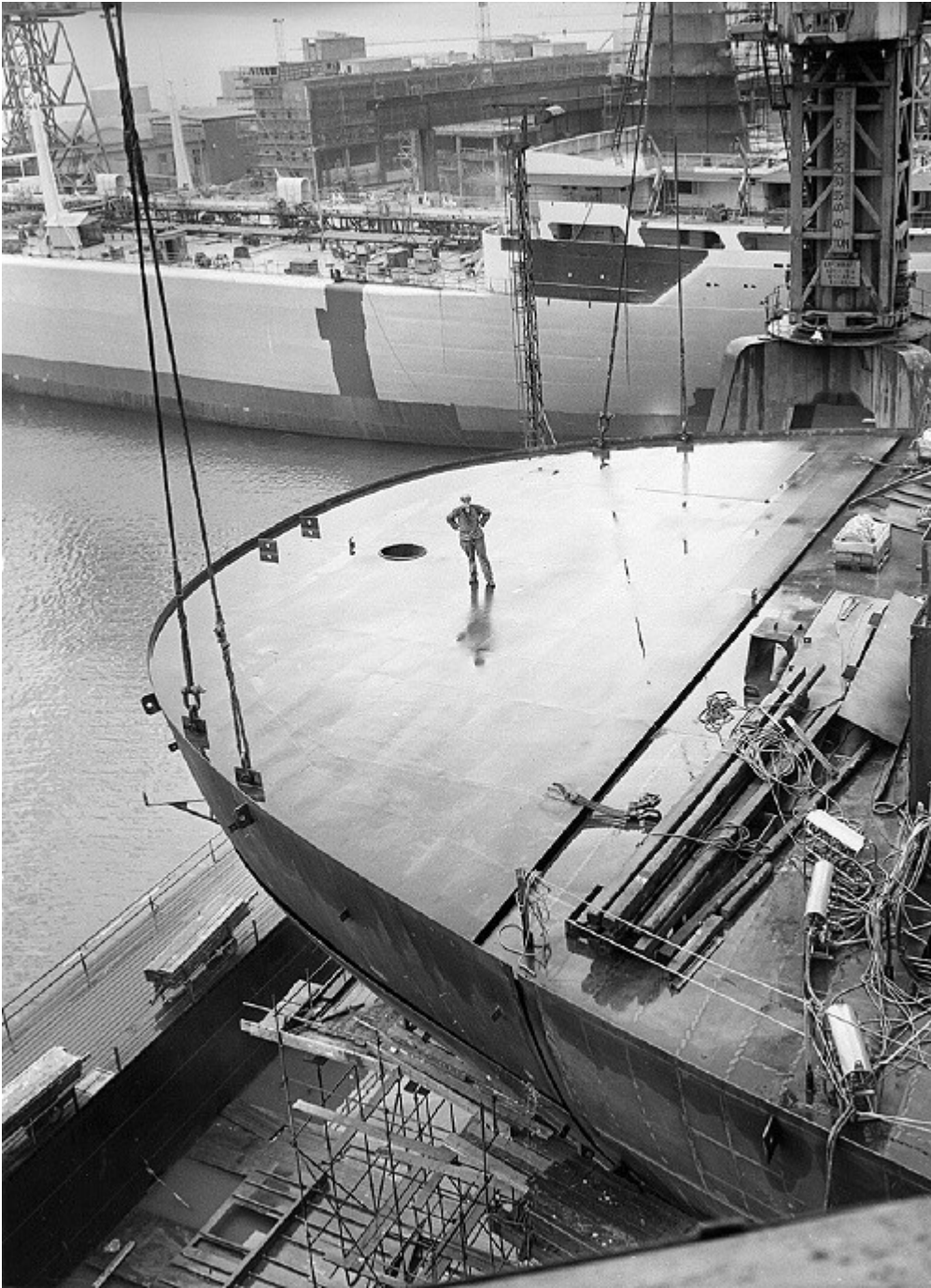
Bnr 472 Turbintankern Esso Yorkshire får här sin aktersektion satt på plats.
